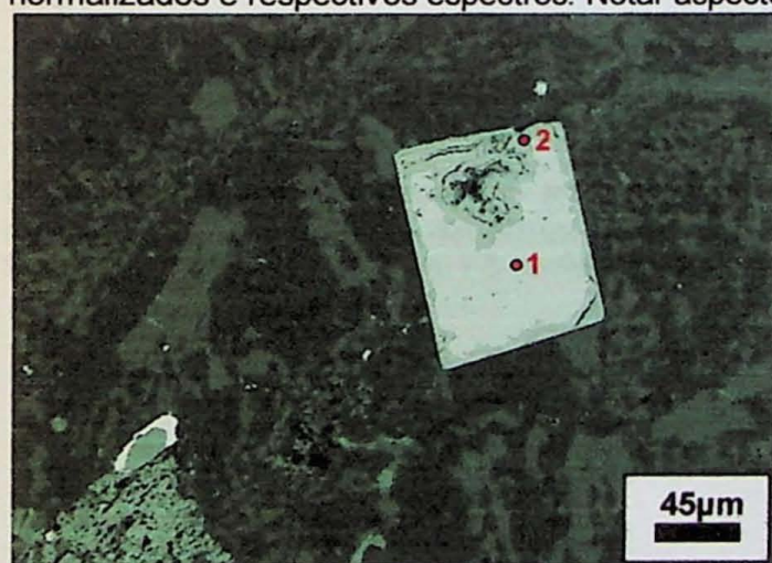
Figura 30: Imagens de elétrons retroespalhados do MEV para lâmina 549a, tabela com os valores normalizados e respectivos espectros. Notar aspecto coloidal e inclusão de sulfetos de As, Co e Fe.
